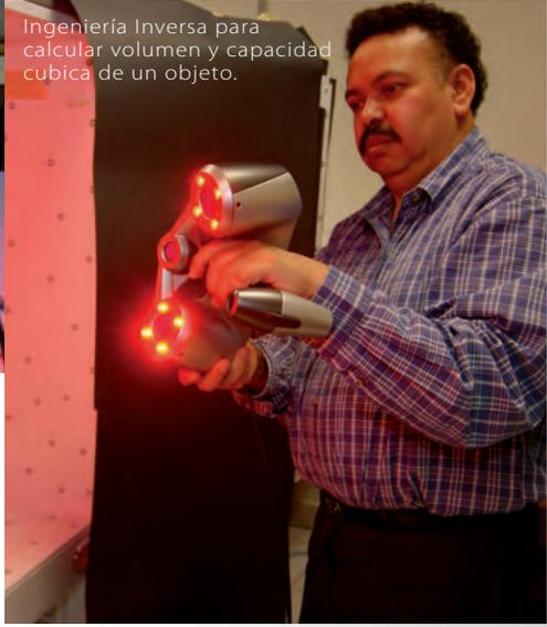
Ingeniería Inversa para calcular volumen y capacidad cubica de un objeto.
