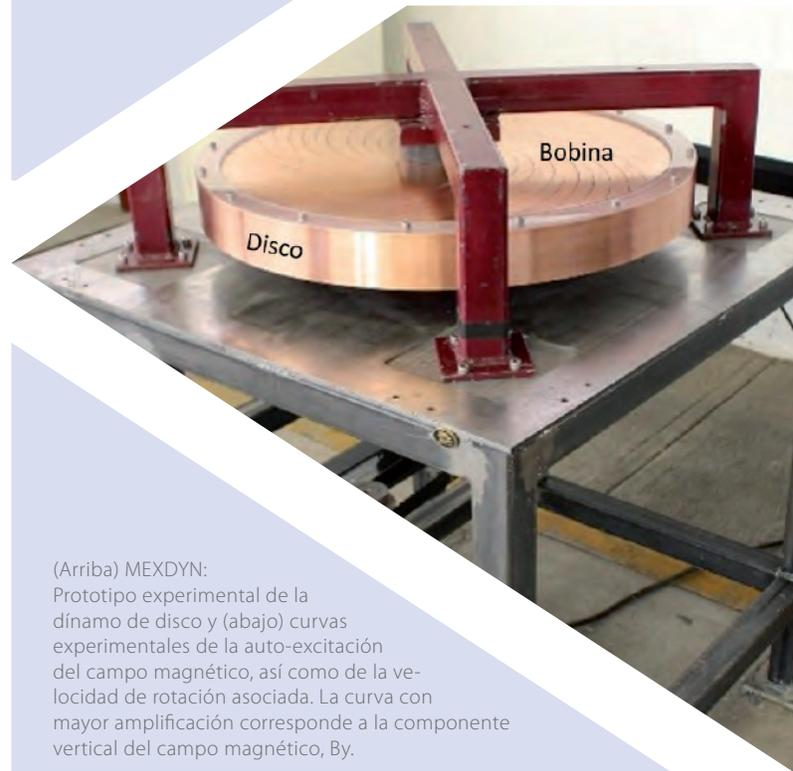
(Arriba) MEXDYN: Prototipo experimental de la dínamo de disco y (abajo) curvas experimentales de la auto-excitación del campo magnético, así como de la velocidad de rotación asociada. La curva con mayor amplificación corresponde a la componente vertical del campo magnético,  $B_y$ .
